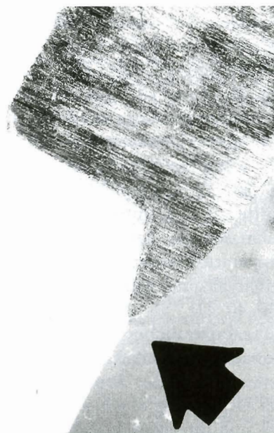
Abb. 8b Approximaler Rand einer Guß- füllung, die mit Luftabzugskanal gegossen wurde.
